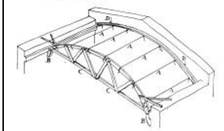
Fig. 3.-Preparación para construir una bóveda cilíndrica empotrada en muros conyes. A-B: Cerriles pesadas paralelas al eje de la bóveda. CC: Espuma para apoyo de la cerrilla. CC': Cerrilla ligera en que se apoya un curso de cerrilla canal. D: Espuma de apoyo de tierra con una boveda ligera en medio de otro curso de cerrilla. E: Muro de la construcción, como en la figura 1. Los cerriles muestran signo de trabajo.
